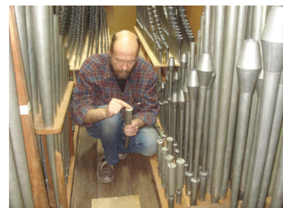
Revisión de tubos durante el proceso de armonización. Foto Gerhard Grenzing S.A. ▶
